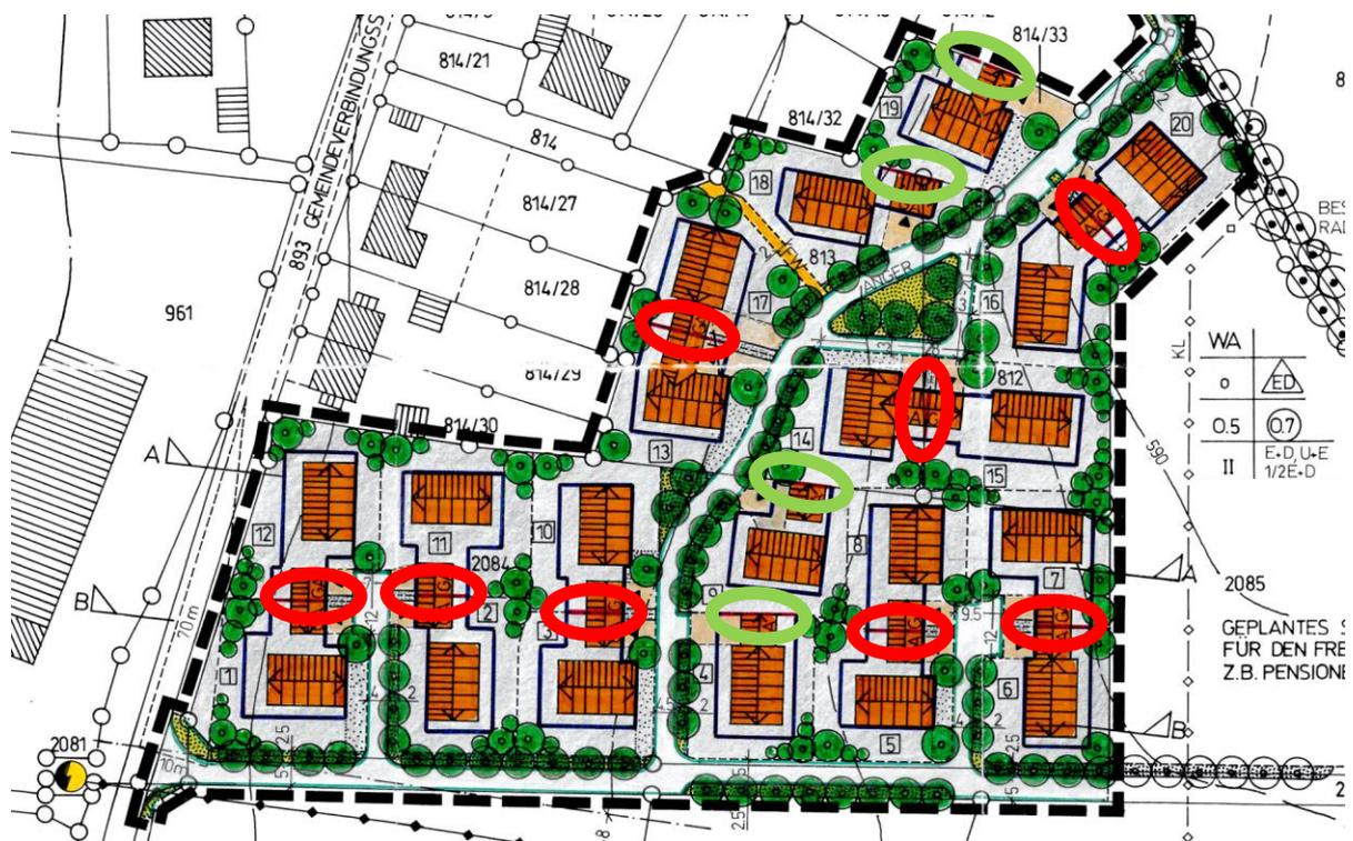
Abbildung 3: Darstellung der Änderung an den Baulinien. In rot: Ausnahme der Baulinien. In grün: Ersatz der Baulinie durch Baugrenzen.
